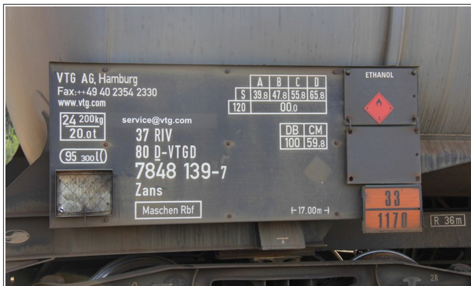
Figure 9 : plaque d'identification d'un wagon avec les numéros MD en bas à droite
