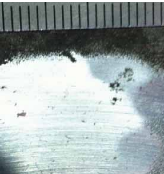
Photo 6 : zone 7 _ reprise de corrosion
