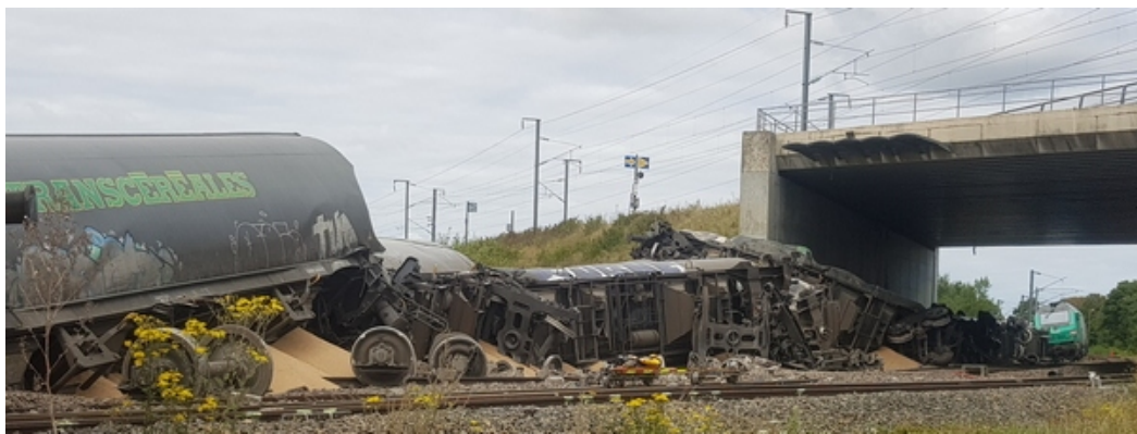
Vue depuis l'ouvrage d'art de la LGV Est-Européenne les wagons 4 (en bas) et 5 (en haut) s'étant ancrés sur le mur de soutien de l'ouvrage Photo SNCF Réseau
