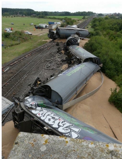
Vue depuis l'ouvrage d'art de la LGV Est-Européenne d'une partie des wagons ayant déraillé, au premier plan le wagon 5 ayant heurté le mur de soutien de l'ouvrage – Photo BEA-TT
