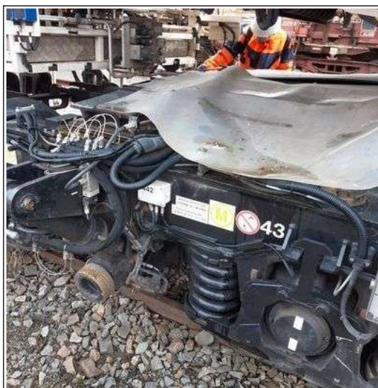
Figure 24 : bâche souple débordant des essieux du bogie 11 (source BEA-TT)
