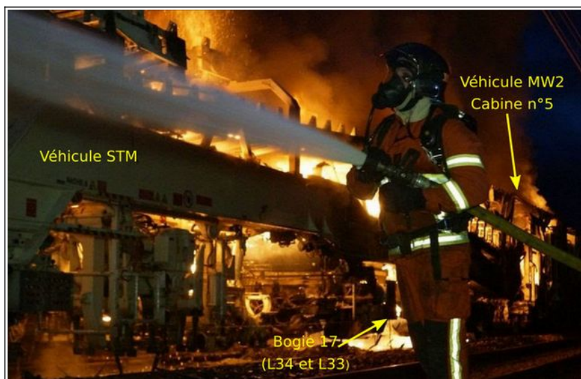
Figure 3 : Train incendié – Protection du réservoir de Gazole du véhicule STM (Source sdis87 modifiée BEA-TT)
