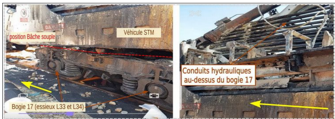
Figure 34 : Bogie 17 du véhicule STM et conduits hydrauliques rigides à sa verticale (BEA-TT)
