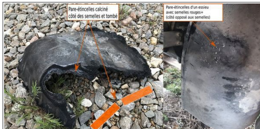
Figure 38 : Pare-étincelles tombé (essieu non déterminé), piqué et resté en place (L37) (BEA-TT)
