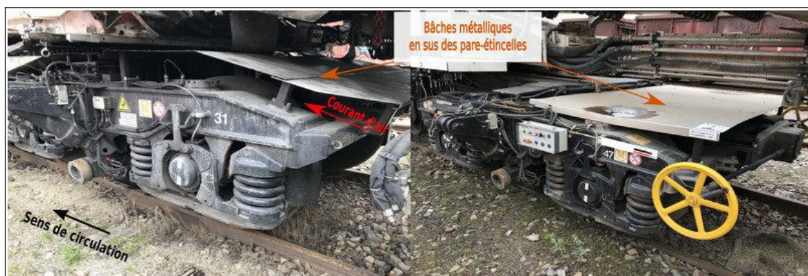
Figure 20 : Essieux avec pare-étincelles et bogie avec carénage rigide métallique bogies 8 (à gauche) et 12 (à droite) (source BEA-TT)
