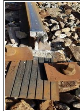
Figure 52 : rupture multiple suite à fissuration verticale longitudinale
