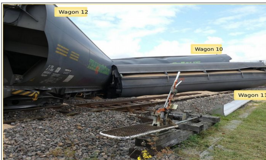
Figure 26 : vue des wagons 12 à 11 déraillés en accordéon avec engagement de la voie 1 (Source BEA-TT)
