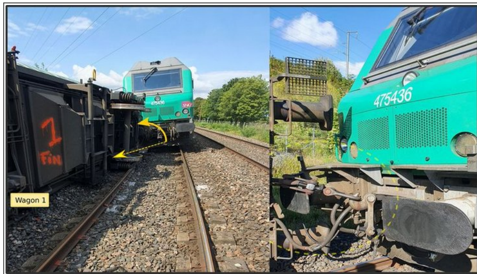
Figure 19 : wagon 1 renversé du fait de la tension avec les wagons encastés dans l'ouvrage et pivot autour de l'attelage de la locomotive
