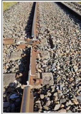
Figure 52 : rupture multiple suite à fissuration verticale longitudinale
