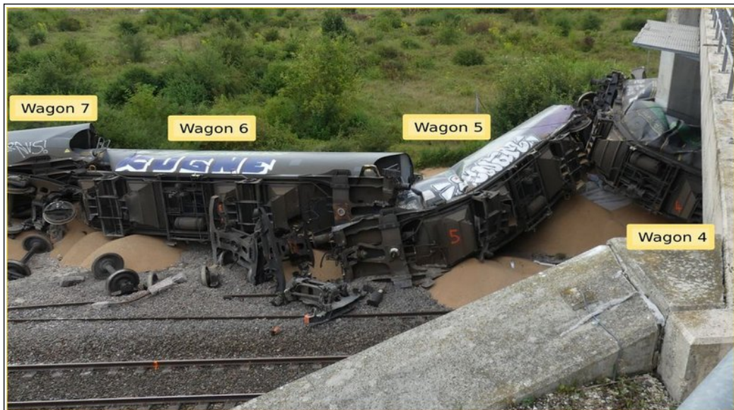
Figure 22 : vue des wagons 4 et 5 « accrochés » sur l'angle du mur en retour du pont-rail (Source BEA-TT)
