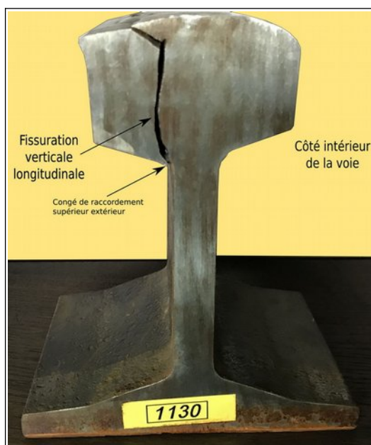
Figure 6 : exemple de fissuration longitudinale verticale du champignon
