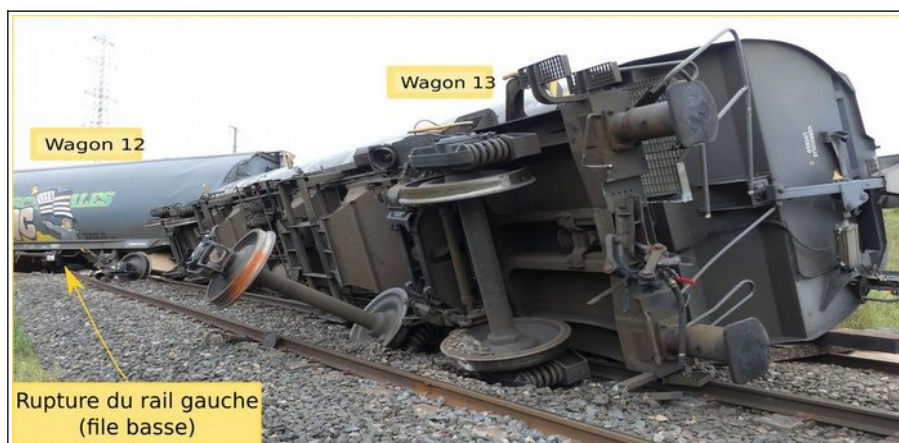
Figure 27 : vue du wagon 13 (dernier wagon déraillé) avant la rupture de rail (Source BEA-TT)
