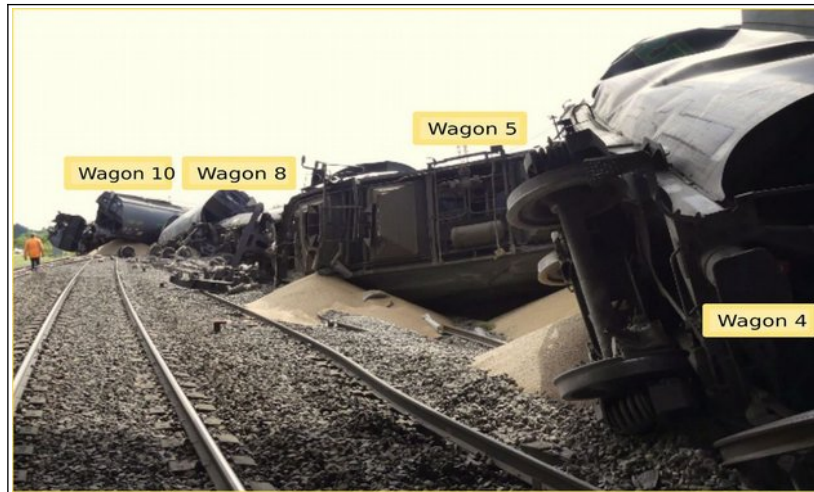
Figure 23 : vue des wagons 4 à 10 déraillés, renversés en alignement (Source BEA-TT)
