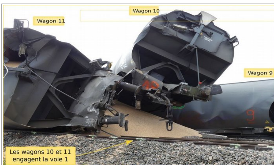
Figure 25 : vue des premiers wagons en « accordéon » (Source BEA-TT)
