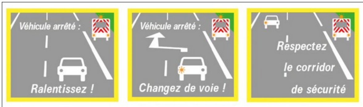
Figure 39 : Signalisation « corridor de sécurité » (source : fondation Vinci autoroutes)
