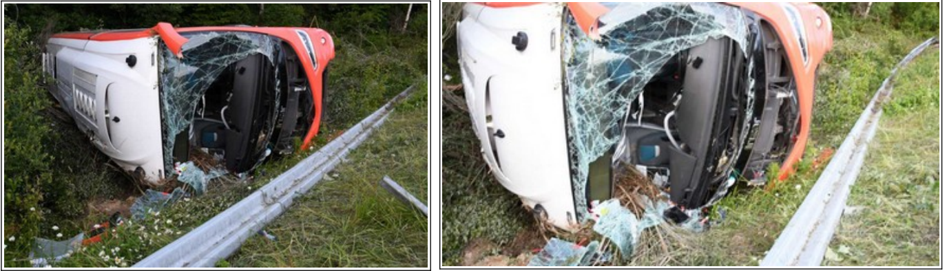
Figure 18 : Vue de l'avant de l'autocar avec la glissière de sécurité déformée et arrachée par sa sortie de route (source : Gendarmerie)
