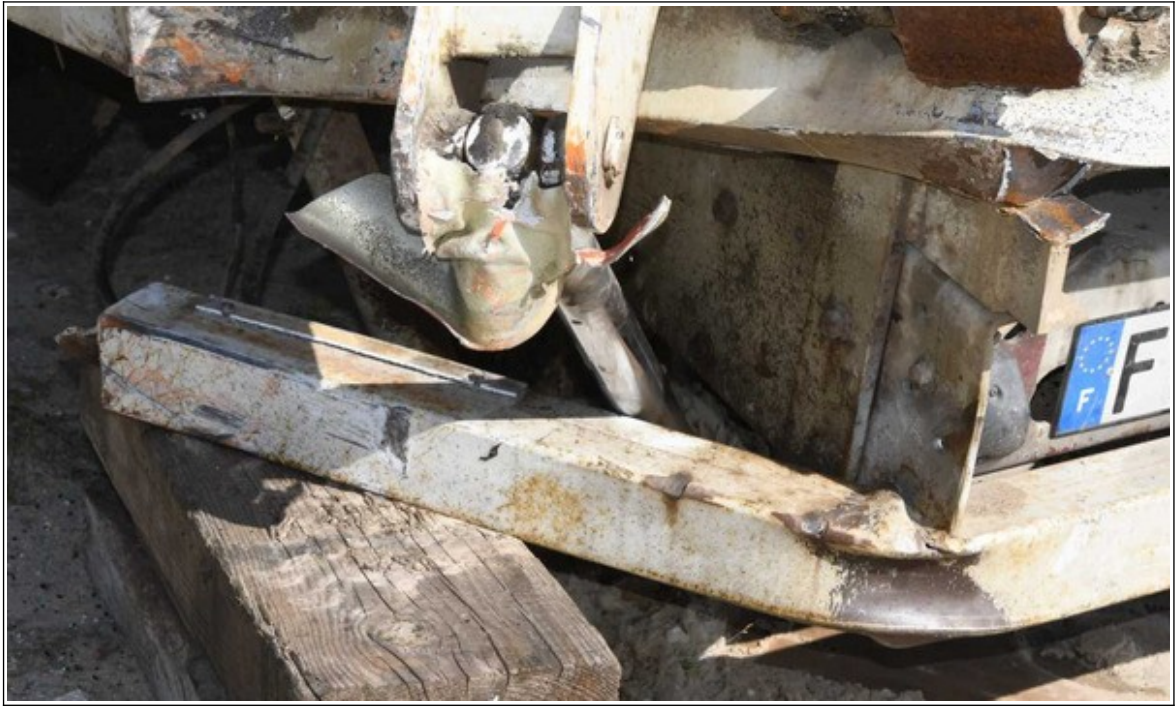
Figure 22 : Barre anti-encastrement enfoncée à l'arrière gauche du camion (source : Gendarmerie)
