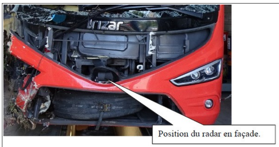
Figure 32 : Avant de l'autocar accidenté avec localisation du radar (source : rapport d'expertise judiciaire)
