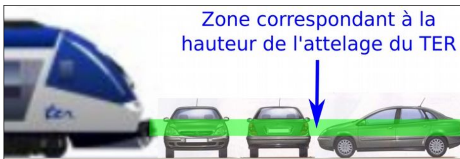
Figure 28 : Visualisation de la zone correspondant à la hauteur de l'attelage du TER Schéma BEA-TT d'après des sources SNCF et Citroën
