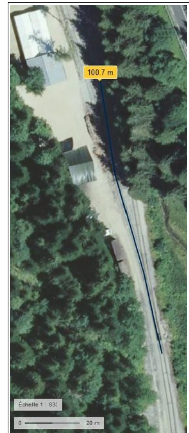
Fig 26 - Distance parcourue par les véhicules en dérive (source Geoportail – les wagons présents sur cette image vue du ciel sont stationnés en voie 3)
