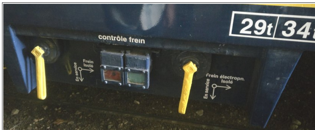
Fig 42 - Indicateurs extérieurs de contrôle des freins du fourgon MC76 (photo BEA-TT)
