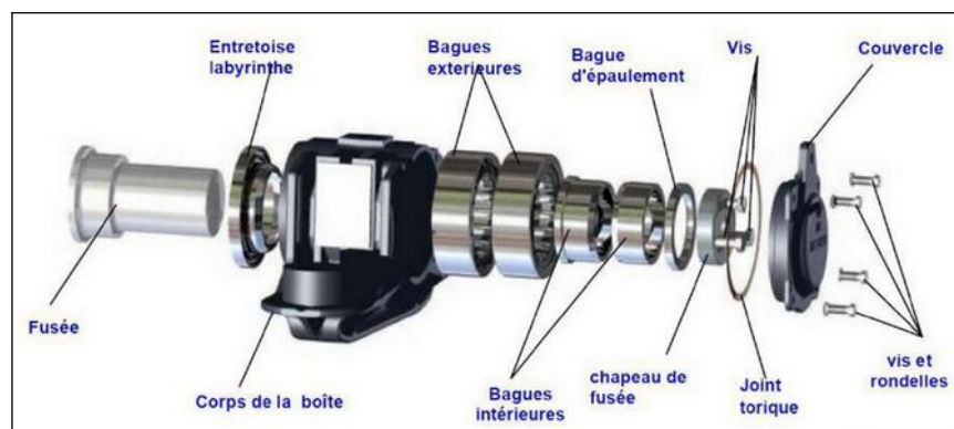
Figure 9 : Vue schématique d'une boîte d'essieu éclatée (Source Valdunes) (nota : les roulements et la boîte représentés ne sont pas du design qui équipe le wagon accidenté)
