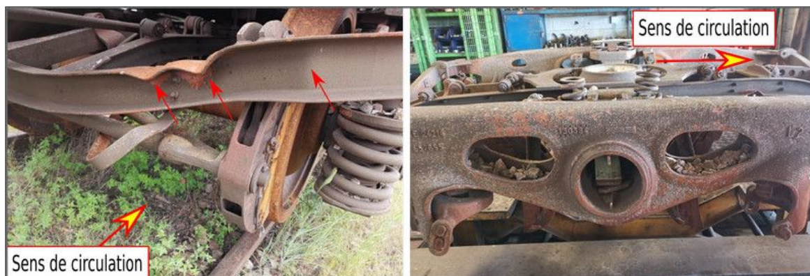
Figure 22 : Déformation de la traverse d'extrémité du châssis du premier bogie du wagon (Source BEA-TT)
