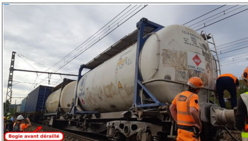
Figure 1 : Wagon de matière dangereuse déraillé (Source SNCF)
