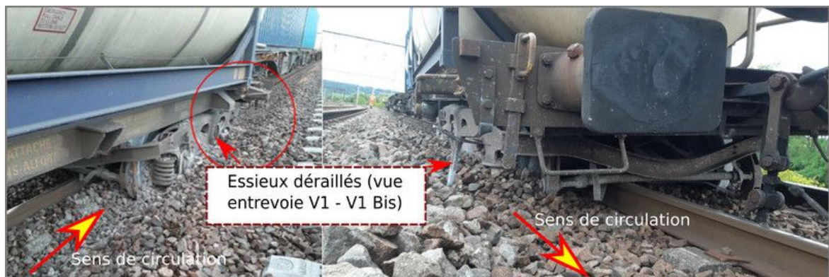
Figure 24 : Bogie déraillé avec boîte manquante (Source BEA-TT)
