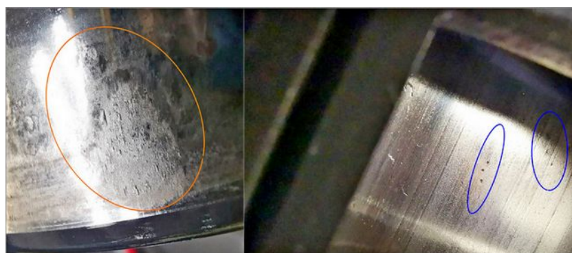
Figure 40 : Gauche : traces de « fretting corrosion » qui témoignent d'un échauffement anormal Droite : de piqûres en chaînette sur la piste intérieure (Source BEA-TT)
