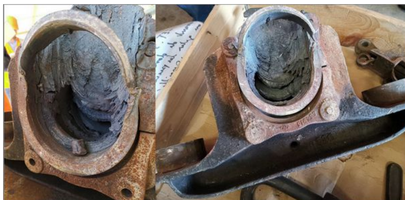
Figure 33 : Vue de l'arrière (côté roue) ; la partie supérieure de la collerette s'était ouverte quand l'essieu s'est séparé de la boîte et refermée à l'éjection de cette dernière dans le ballast (Source BEA-TT)
