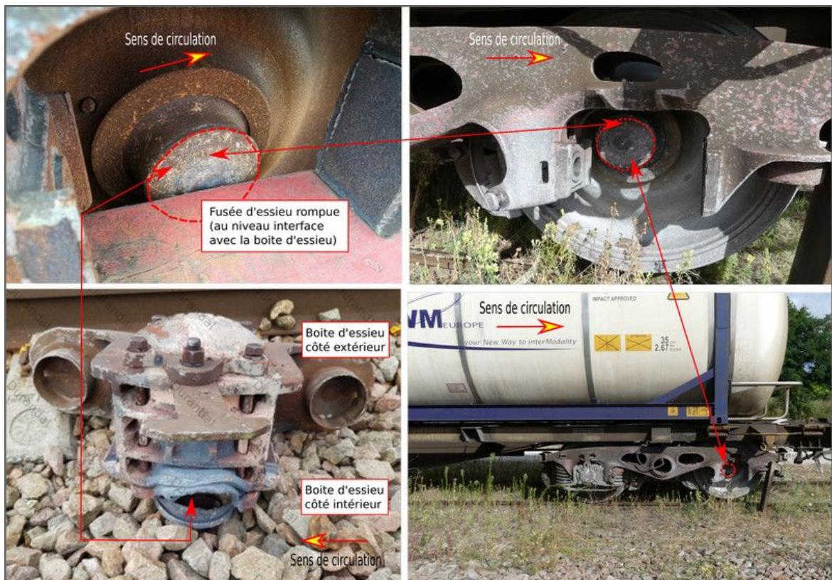
Figure 21 : Fusée et boîte d'essieu disparues – La boîte d'essieu a été retrouvée au Pk 123,605 à l'extérieur de la voie 1bis (Source BEA-TT)
