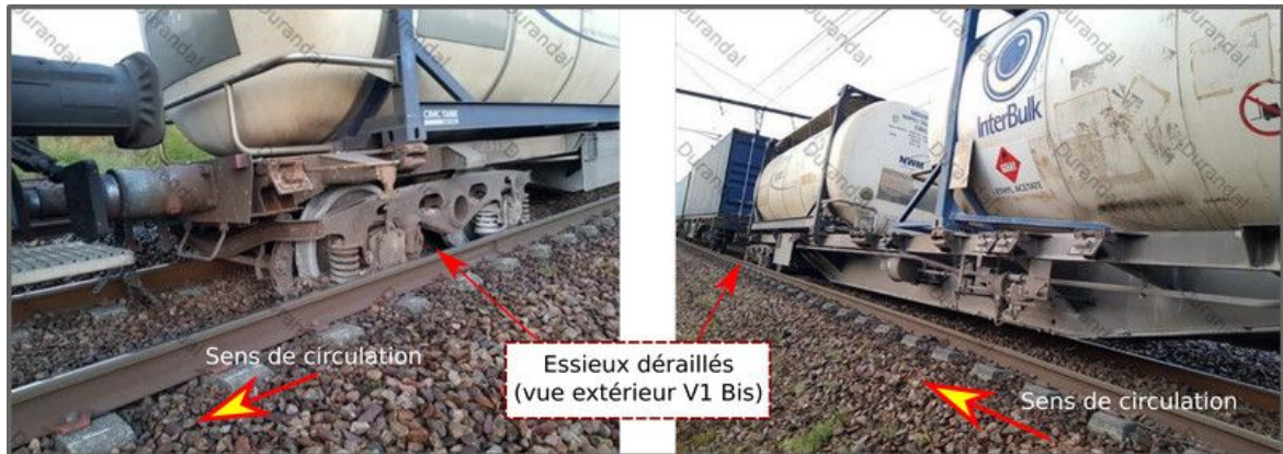
Figure 20 : Le wagon accidenté-déraillé dans son état final sur la voie 1bis (Source SNCF)
