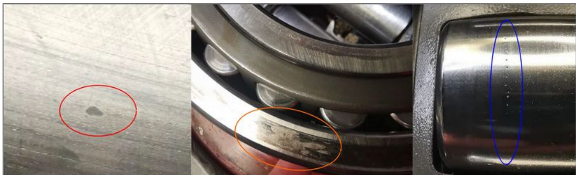
Figure 39 : Gauche : traces de martelage d'un rouleau par des corps étrangers Milieu : « fretting corrosion » – Droite : Piqûres en chaînette sur rouleau (Source BEA-TT)
