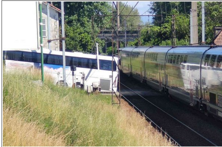
Figure 9 : visualisation grâce à l'autocar du profil en long de la route entre l'avenue Albert 1 er et le PN n° 238. La lisse de la barrière repose sur l'arrête gauche du toit de l'autocar. photo SNCF Réseau
