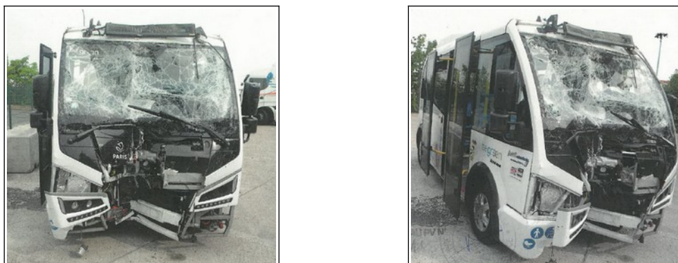
Figure 14 : enfoncement avant dû au choc contre un poteau « porteur » à l'intérieur du magasin (photos Police)
