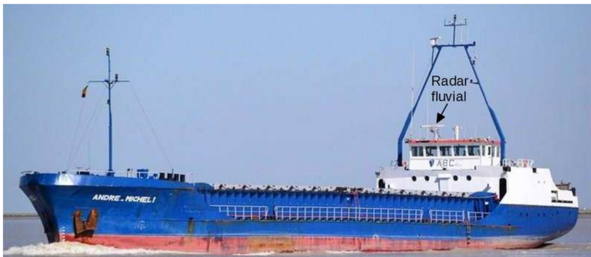
Navire ANDRE-MICHEL 1 en configuration mer (la passerelle, le mât principal et le mât avant sont déployés)
