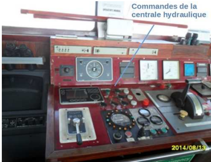
Console de commande côté bâbord, vue en regardant vers l'avant du navire. Source : ABCRM
