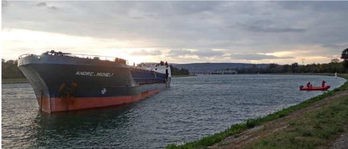
Vue depuis la berge en rive droite du navire immobilisé et de son assiette « sur le cul » Source : Gendarmerie (photographie prise le 3 octobre 2021 à 8 heures)
