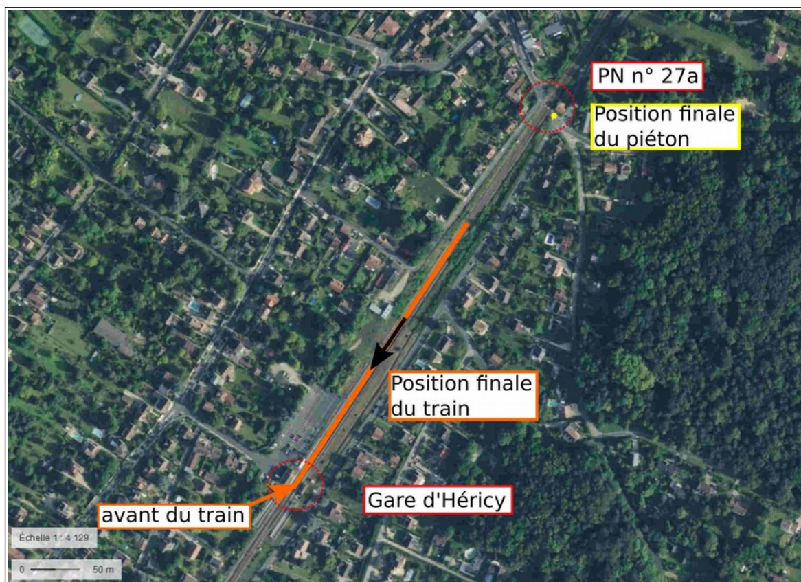
Figure 11 : Positions finales du train et du piéton après la collision (vue aérienne Géoportail-IGN et légende BEA-TT)
