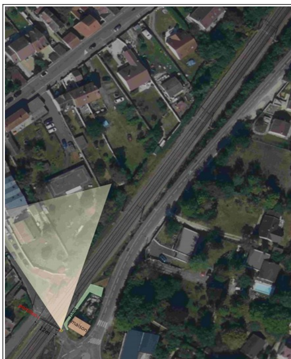
Figure 24 : schéma des conditions de visibilité au niveau du portillon pour un piéton arrivant par l'est au PN. (image aérienne Géoportail-IGN, légende BEA-TT)
