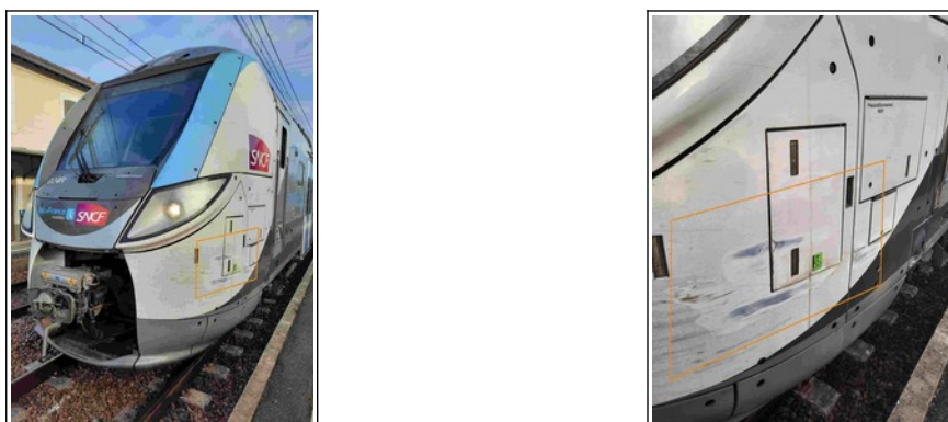
Figure 14 : photos de la motrice après la collision. (source conducteur du train – SNCF, modifiées par le BEA-TT)
