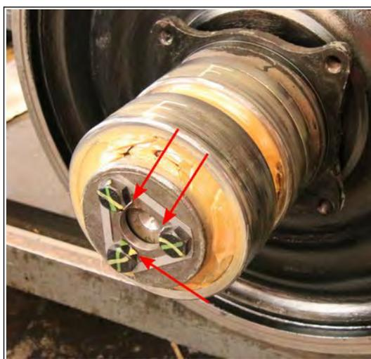
**Figure 14 - exemple de chapeau de fusée avec tôle et ergots métalliques repliés** (photo BEA-TT)
