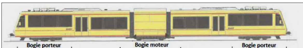
Fig 15 : Schéma d'une automotrice Z150 (source SNCF)
