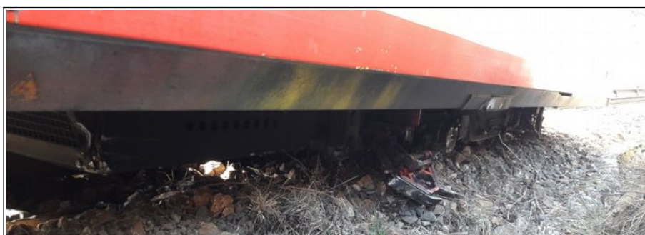
Fig 32 Déraillement du bogie arrière (photo SNCF)
