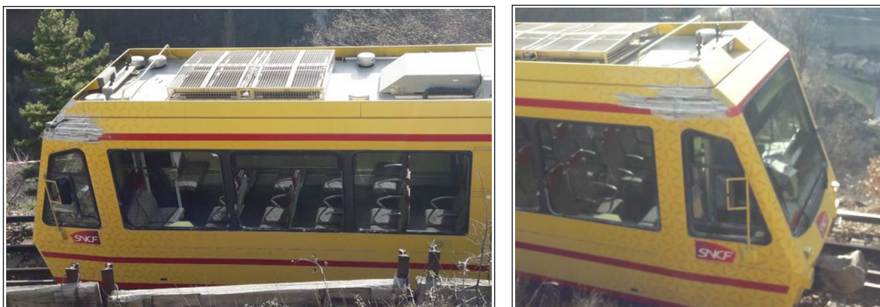
Fig 30 : Impacts côté gauche de la Z152 (photos SNCF)
