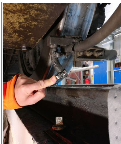
Fig 66 : Graisseur de rail installé sur une Z100 avec angle d'inclinaison maximal du flexible (photo BEA-TT)
