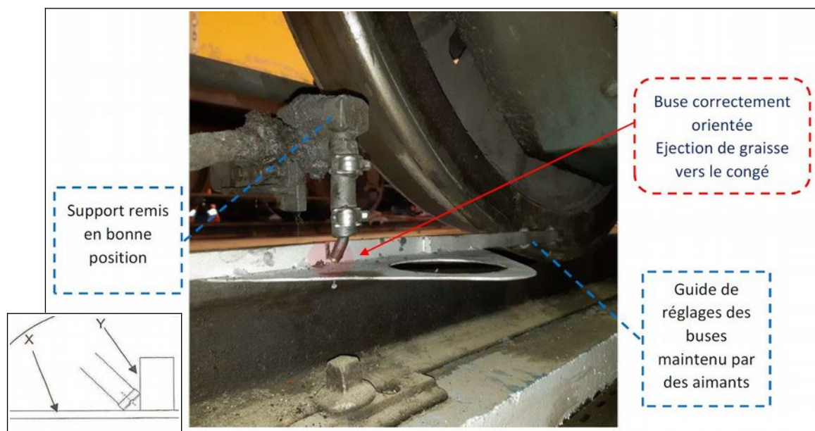
Fig 64 : Remise en position nominale du support et de la buse d'éjection sur une roue de la Z108, avec l'aide du calibre de réglage (source SNCF)
