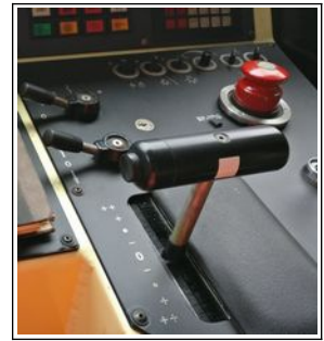
Fig 17 : Manipulateur du frein électrique de la Z152 (photo BEA-TT)
