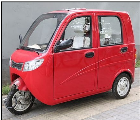
Figure 19 : Tricycle à moteur carrossé, de genre « voiturette », d'une puissance inférieure à 15 kW
