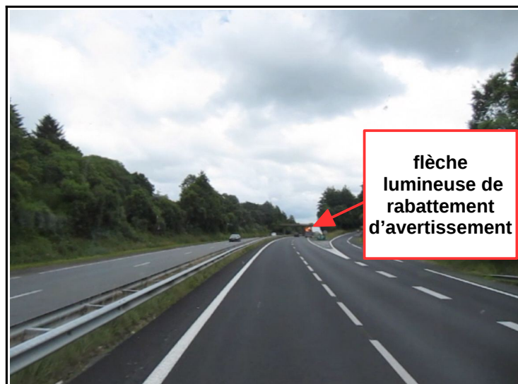
Figure 11 : La remorque portant la FLR d'avertissement telle qu'elle était visible à 150 mètres lors de la mise en situation du 19 juillet 2012
