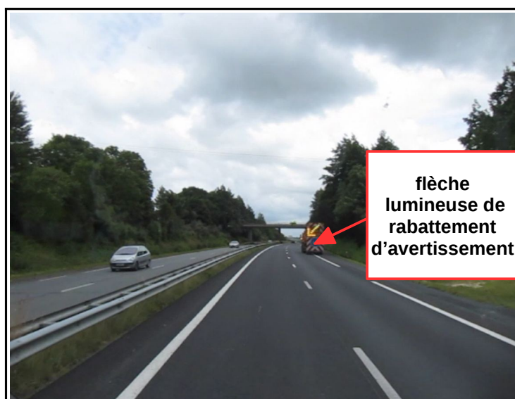
Figure 12 : La remorque portant la FLR d'avertissement telle qu'elle était visible à 50 mètres lors de la mise en situation du 19 juillet 2012
