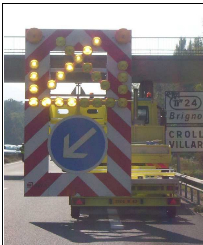
Figure 15 : Camion benne équipé d'une FLR déportée
