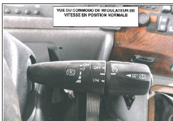
Figure 35 : Vue de l'interrupteur de commande du régulateur en position normale
