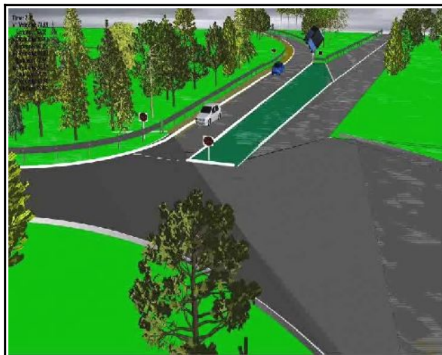
Figure 48 : L'autocar (A) bascule progressivement dans le virage tout en freinant
