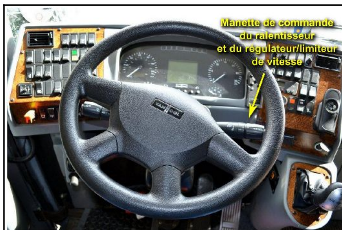
Figure 18 : Emplacement de la manette de commande du ralentisseur et du régulateur / limiteur de vitesse
