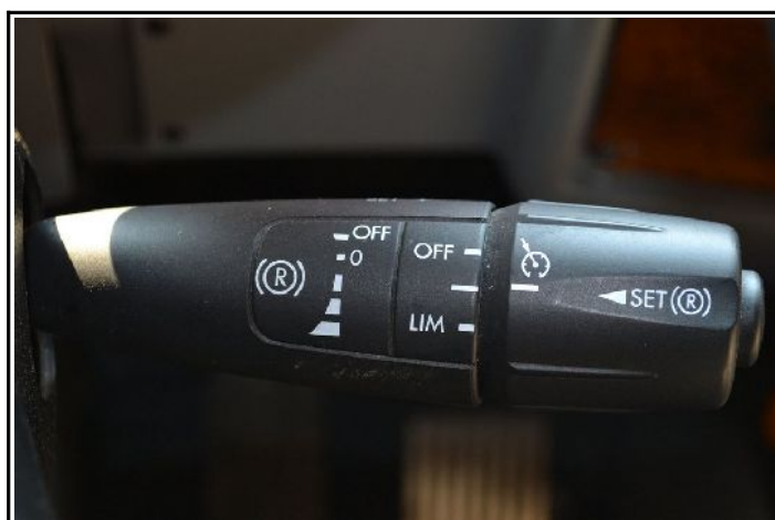
Figure 19 : Vue rapprochée de la manette de commande du ralentisseur et du régulateur / limiteur de vitesse
