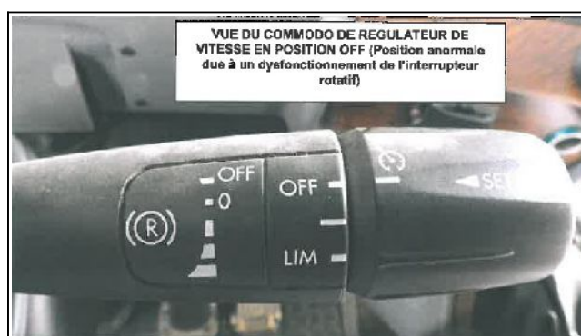
Figure 36 : Vue de l'interrupteur de commande du régulateur en position "OFF"
