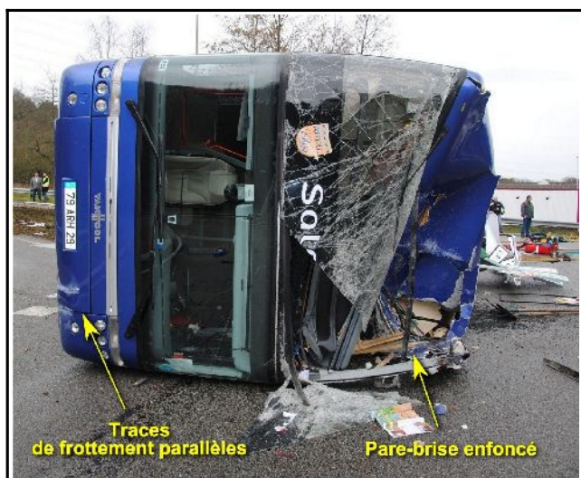
Figure 30 : Vue des dégâts causés à la face avant de l'autocar
