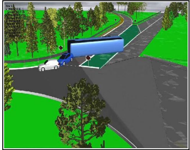
Figure 50 : L'autocar (A) glisse sur son flanc gauche et vient percuter le véhicule Peugeot 407SW (B) qui le précédait
