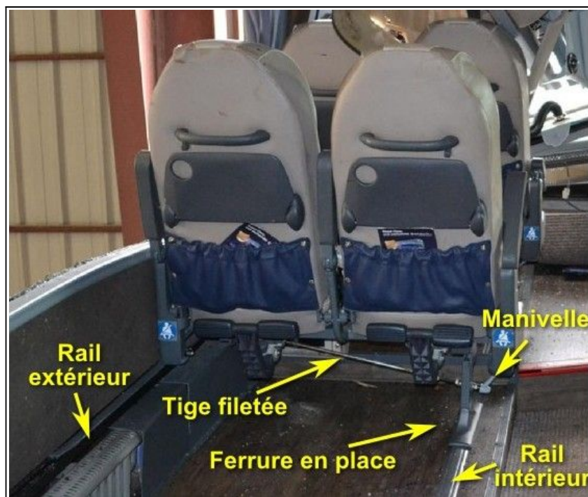
Figure 28 : Vue de l'arrière d'un siège et de son système de fixation
