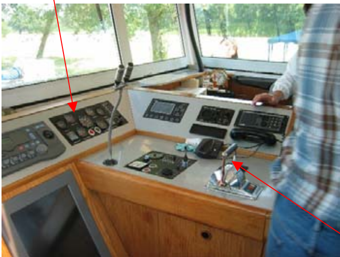
Pupitre timonerie tribord avec le tableau de démarrage/contrôle du moteur de propulsion et le levier de commande
