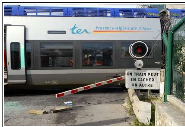
Figure 15 : Vue n° 4 - Le passage à niveau, vu du côté de l'allée des Grillons. La demi-barrière est pliée vers l'extérieur de ce passage à niveau.
