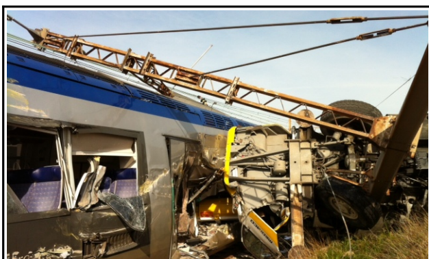
Figure 16 : Vue n° 5 - La grue mobile encastrée dans l'automotrice de tête et écrasant un poteau support de la caténaire, vue depuis l'avant du train accidenté
