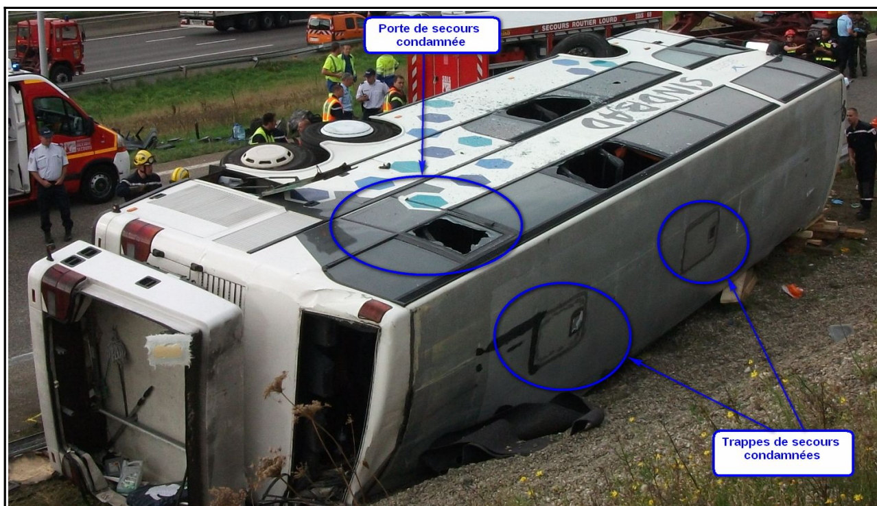
Figure 25 : Vue des issues de secours condamnées
