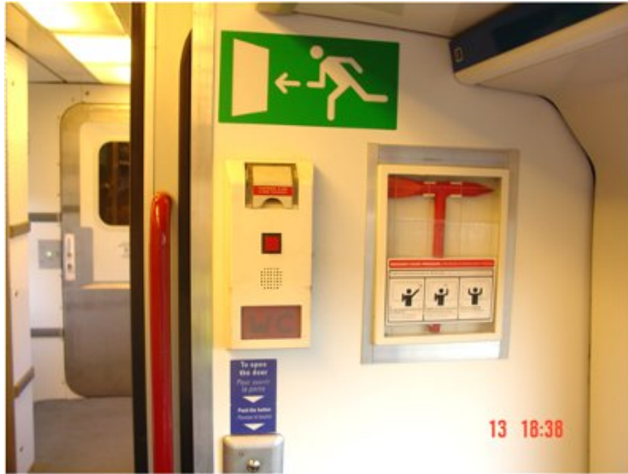
figure 25 : voiture aménagée, marteaux brise vitres
