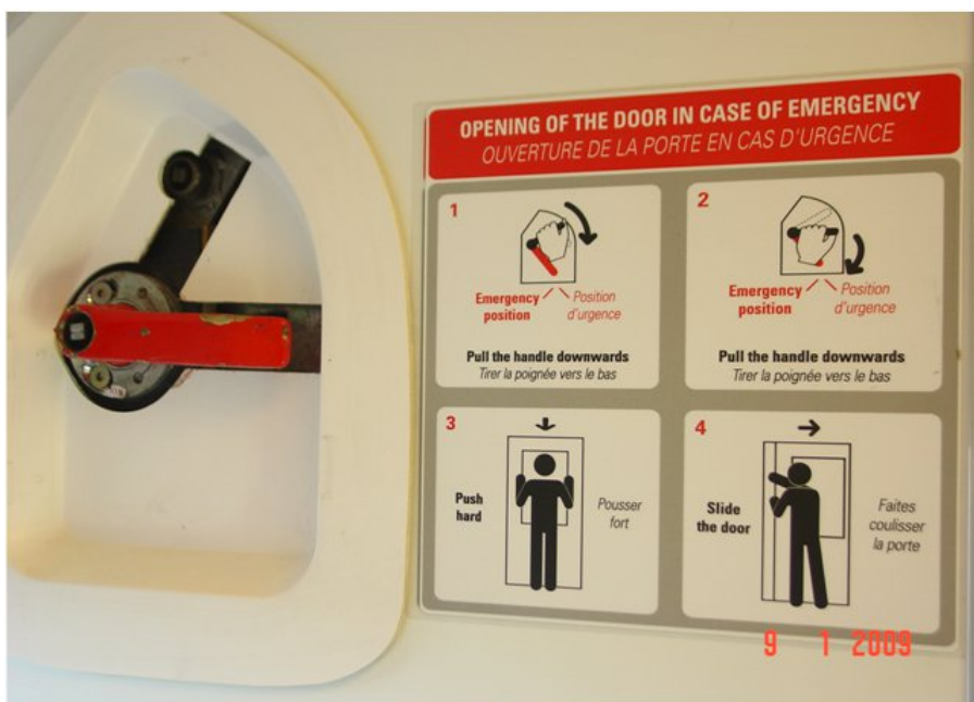
figure 21 : voiture aménagée, dispositif manuel, à poignée, de déverrouillage d'une porte
