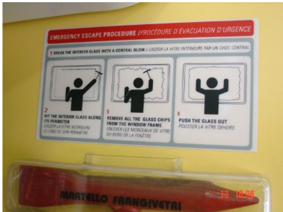
figure 24 : voiture aménagée, procédure d'évacuation d'urgence
