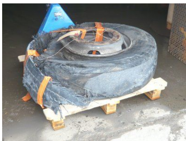
État du pneumatique avant droit de l'autocar après l'accident
