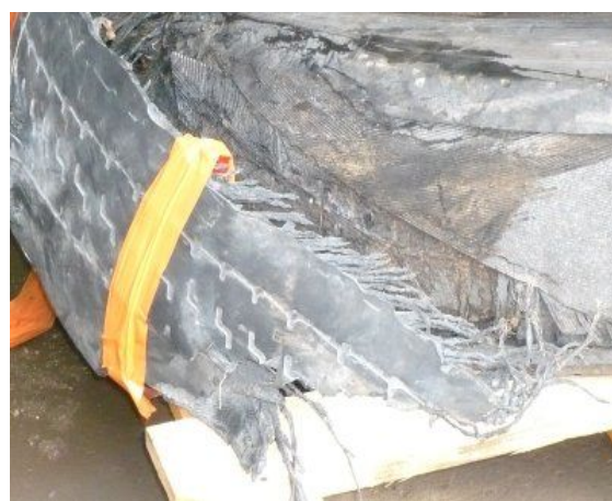
État du pneumatique avant droit de l'autocar après l'accident
