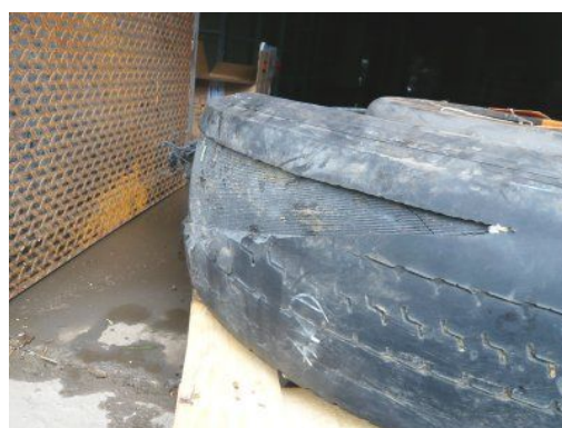
État du pneumatique avant droit de l'autocar après l'accident
